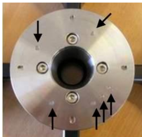
Abb. 32: Magneten an der Unterseite des Rotors
