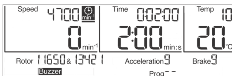
Abb. 19: Die Funktion "Laufzeit ab Solldrehzahl" ist aktiviert
