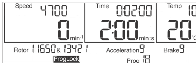
Abb. 26: Die Programmsperre "ProgLock" ist aktiviert
