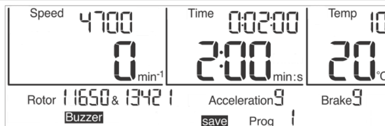
Abb. 30: Speichern eines Programms
