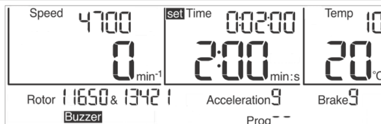
Abb. 18: Einstellen der Laufzeit, hier in der Zeiteinheit "min:s"
