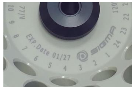
Abb. 8: abweichende Lebensdauer – Gravur auf dem Becher / Rotor
