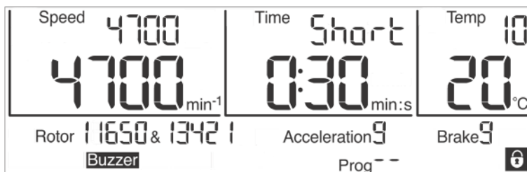
Abb. 21: Anzeige "Short" während des Kurzzeitbetriebs
